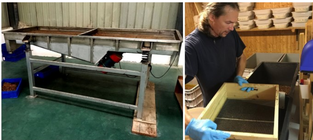
شکل ۱۷: غربال تکانی خودکار (سمت چپ) و الک دستی (راست) برای جداسازی لاروها از بقایای خشک
