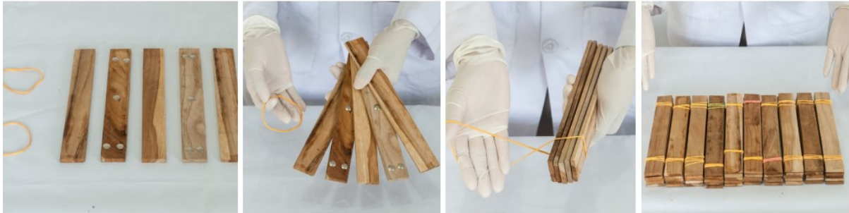
ورق‌های چوبی با چند پونز که برای ایجاد فاصله بین چوب‌ها زده می‌شود. هر تخم‌گاه با دو بند لاستیکی محکم می‌شود (R1-10).
