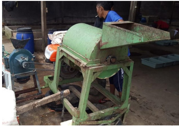
شکل ۱۵: آسیای چکشی برای پیش‌پردازش پسماند
